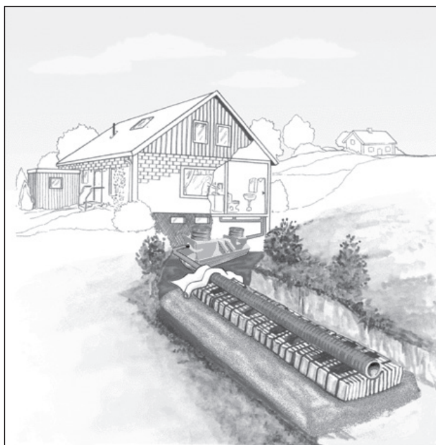
Figur 2. In Drän infiltrationssystem
