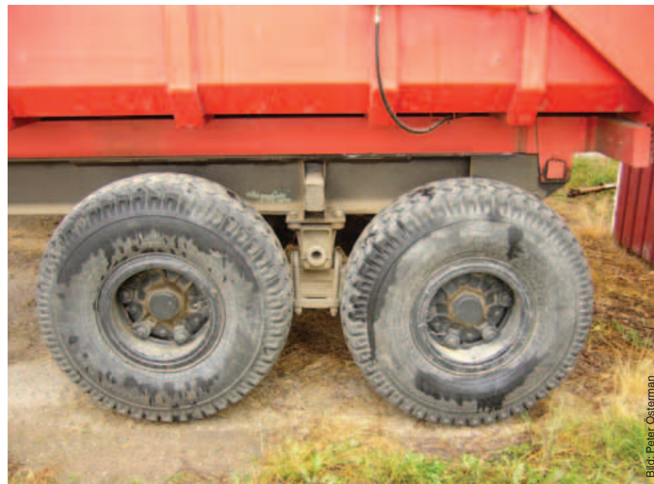
När man kör på våt åker får inte däcktrycket överskrida 50 kPa.
