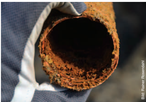
Bild 4. Rostutfällning, dags för spolning.
