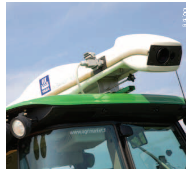
Mätenheten som placeras på traktorns hytt mäter grödans klorofyll och biomassa på en 50 m 2 yta.
