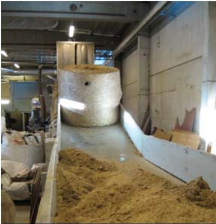
Rundbalar på transportbandet väg upp mot den långsamtgående grovkvamen på Biobräsletekniskt center i Umeå. I förgrunden litet riven rörflen
