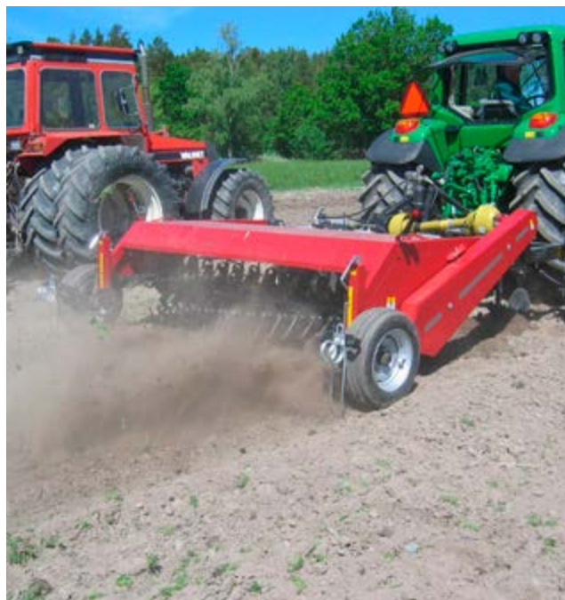
↑ För svartträda används vanligtvis fjäderharv men också annan bearbetningsutrustning kan användas. KvickFinn på bilden skär av ogräsen rötter och lyfter effektivt upp dem till markytan.
