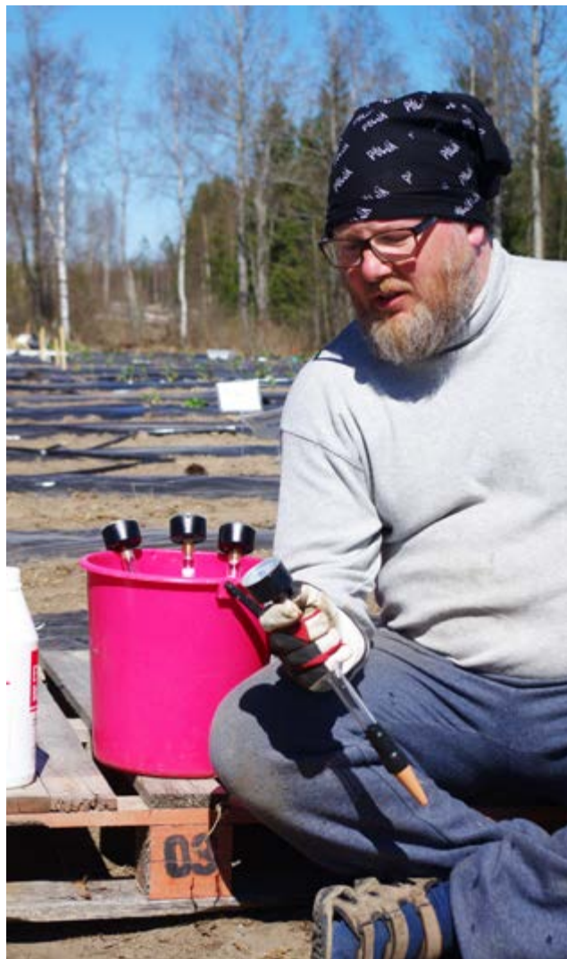
↑ En tensiometer är den billigaste investeringen, under 100 €. Med hjälp av den kan man följa med markens fuktighet och den är till hjälp när man ska bestämma tidpunkter för bevattning.
