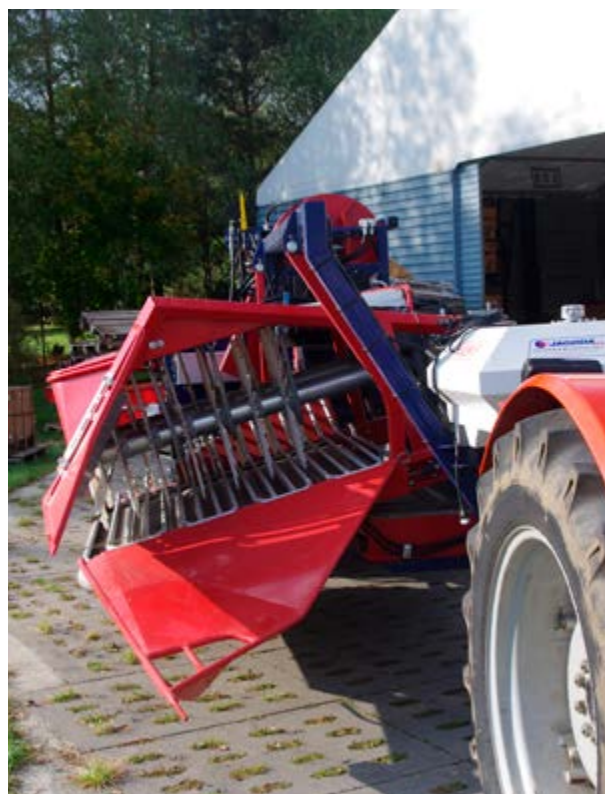
↑ En traktordragen polsk vinbärströska som skördar halva busken åt gången.
