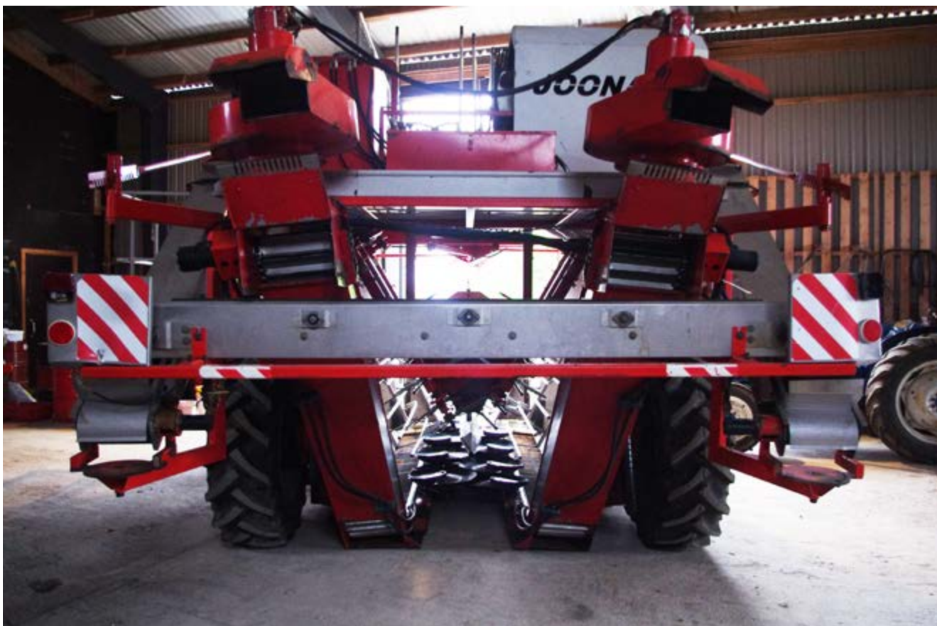
↑ Den inhemska vinbärströskan Joonas är självgående. På bilden visas maskinen bakifrån.
